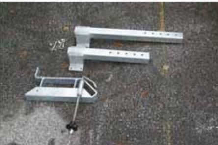
31. Die Auflagekonsolen werden an den beiden Seitenteilen des Rainstars montiert. Die entsprechenden Bohrungen sind bereits vorhanden. Die längere Konsole wird an der Antriebsseite des Rainstars montiert.
