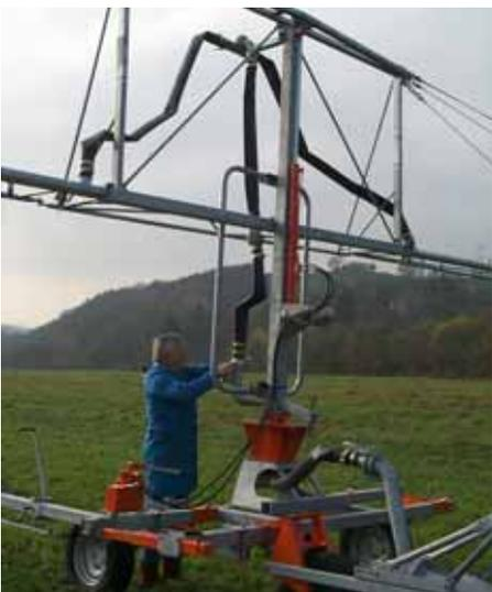
34. Für höhere Kulturen kann das AS 50 mit einer hydraulischen Höhenverstellung ausgerüstet werden. Mit einer hydraulischen Handpumpe wird der Ausleger bis zu 2,5m freier Höhe angehoben. Für die Wasseranspeisung wird eine Schlauchverlängerung zwischengekuppelt. Die beiden Ausgleichsgewichte sind wieder etwas über dem Bodenniveau einzuhängen.
