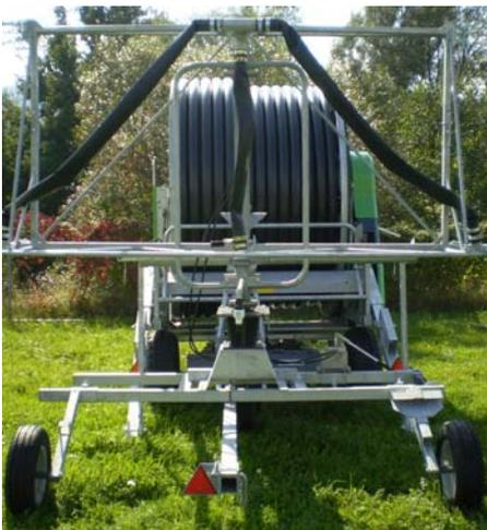
7. Der Wasserführungsschlauch wird mit dem Wasserführungsrohr gekuppelt und am Mittelsteher mit Schlauchbindern befestigt. Für eine knickfreie Schlauchführung ist die Schlauchlänge anzupassen.
