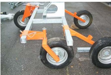
9. An der gegenüberliegenden Seite wird das um 360° drehbare Stützrad montiert. Die Befestigungskonsole mit der Drehachse zeigt dabei nach hinten.
