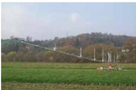
28. Um eine bessere Stabilität des kompletten Auslegers zu erhalten, ist es von Vorteil wenn die jeweils äußeren Auslegerrohre leicht nach oben gezogen montiert werden.
