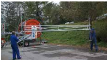
22. Das 2. Auslegerrohr, gemeinsam mit dem 3. wird mit Hilfe eines Tragbügels ausgeklappt.
