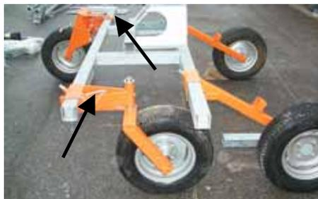
35. Arretierung am drehbaren Stativrad und am Zugrad lösen. ( Arretierung nur für Transport am RAINSTAR )
