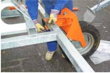
2. Das vordere lenkbare Rad wird vorne in der Mitte des Fahrgestelles montiert.
