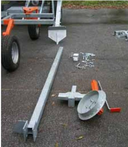
10. Die Ausziehdeichsel wird auf der Seite des lenkbaren Rades (in Linie mit dem PE-Rohr) montiert. Beim 3-Rad Wagen wird die Deichsel in Wagenmitte montiert. Die verschiebbare Konsole für den Kettenspannhebel wird vorher auf die Deichsel aufgeschoben.
