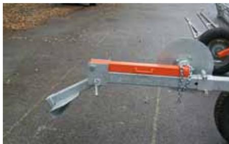
37. Die Ackerschiene in den Ausziehhaken einhängen und das Auslegerstativ im aufgeklappten Zustand ausziehen.
