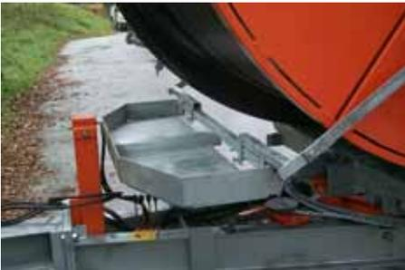
33. Wird ein Rainstar Modell E1, E1Plus, E11 und E2, E2Plus, E21 für den Betrieb eines AS 50 verwendet, ist eine Gewichtsablage auf dem Gerät zu montieren. Diese Gewichtsablage ist mit ca. 120 kg Sand- oder Betongewichten zu belasten, um eine ausreichende Stabilität des Rainstars, besonders bei seitlich angehobenem AS 50 zu gewährleisten.
