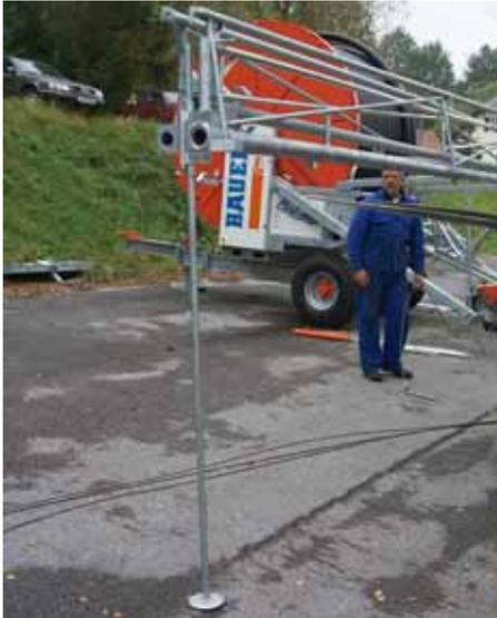
20. Das Abstützen der ersten Auslegerrohre mit den einstellbaren Stützen verhindert ein Pendeln des Systems und erleichtert somit die weitere Montage. Das Seil Nr. 1 wird am Rohr eingehängt, die Seile 2, 3 und 4 werden ausgelegt, durch die Sailabstützungen gezogen und zum Einhängen vorbereitet.
