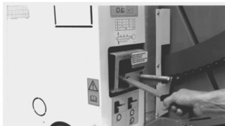
36. Stativ langsam absenken (siehe Anleitung Rainstar) und Getriebeschalthebel in Stellung „PE-Rohrauszug“ bringen
