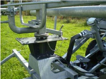
6. Der Mittelsteher mit dem angeschraubten Zwischenstück wird auf die Flanschplatte des Fahrgestelles aufgesetzt und verschraubt. Der Haken zum Hochheben des Statives zeigt dabei in Richtung des vorderen lenkbaren Rades. Die Schlauchtülle zeigt nach vorne (nicht bei 4 – Rad Wagen)
