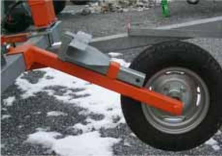
39. Während des Einzuges des AS 50 wird der Ausziehhaken abgekuppelt und in eine Transportöse gesteckt. Das Spurrad wird abgesenkt, die Kette eingehängt und mit dem Hebel fest in den Boden gedrückt. Mit der verschiebbaren Arretierschraube wird der Spannhebel fixiert.
