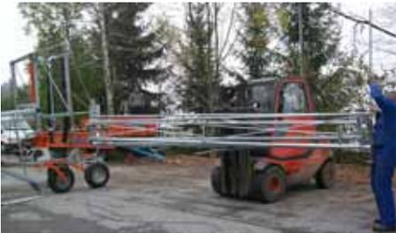
19. Die Auslegerrohre müssen immer schrittweise rechts und links zusammengebaut und mit den Seilen abgespannt werden. Ein fertiges Auslegerpaket, bestehend aus 4 Auslegerrohren mit Windverband, wird mittels Bolzen am Mittelteil befestigt.
