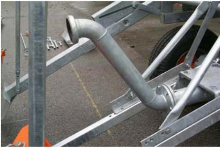
5. Das Wasserführungsrohr wird mit dem Flansch des Horizontalrohres verschraubt.
