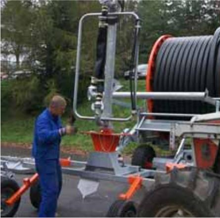
12. Der Mittelsteher mit dem angeschraubten Zwischenstück wird auf die Flanschplatte des Fahrgestelles aufgestellt und verschraubt. Der Haken zum Hochheben des Stativs zeigt dabei in Richtung des vorderen lenkbaren Rades. Die Schlauchtülle zeigt, je nach PE-Rohreinlauf in den Rainstar, schräg nach links oder rechts nach vorne.
