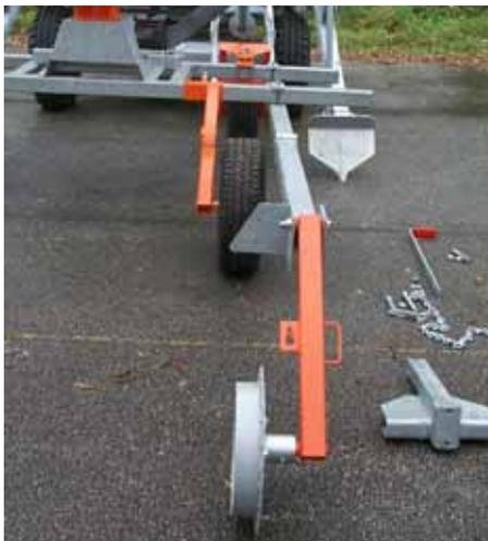
11. Das Spurrad (nur bei 4-Radwagen) wird so montiert, dass das Rad in der Fahrspur der Wagenräder und in Linie mit dem PE-Rohr liegt. Kettenspannhebel und Kette werden auf verschiebbarer Konsole montiert.
