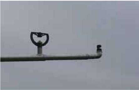
29. Entsprechend der gewünschten Düsenbestückung werden die Sprüh – oder Rotatordüsen mit einer Teflonbanddichtung eingeschraubt.
