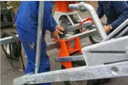
13. Der Wasserführungsschlauch wird mit dem Wasserführungsrohr gekuppelt und am Mittelsteher mit Schlauchbindern befestigt. Für eine knickfreie Schlauchführung ist die Schlauchlänge anzupassen.
