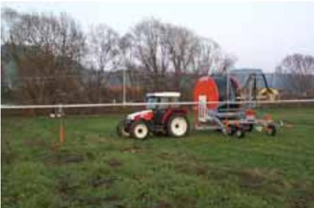
40. Nachdem das AS 50 die Endposition am Rainstar erreicht hat, und das Gerät abgeschaltet hat, kann der Rainstar und das AS 50 in die nächste Position überstellt werden. Als erstes wird das AS 50 hydraulisch angehoben, danach wird es in die nächste Arbeitsposition gebracht.
