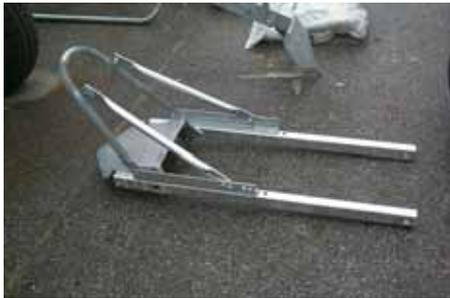
3. Die einstellbare Abschaltflosse gemäß Plan zusammenbauen und mit dem Horizontalrohr verschrauben.
